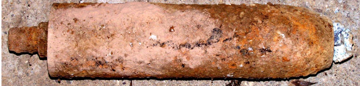
Projectiles explosifs ou fumigènes au phosphore pour mortier américain de 106 mm
