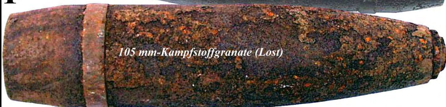
F Obus chimique de 105 mm (Ypérite)
