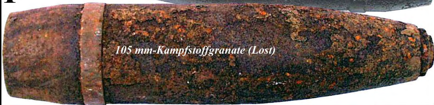
Obus chimique de 105 mm (Ypérite)
