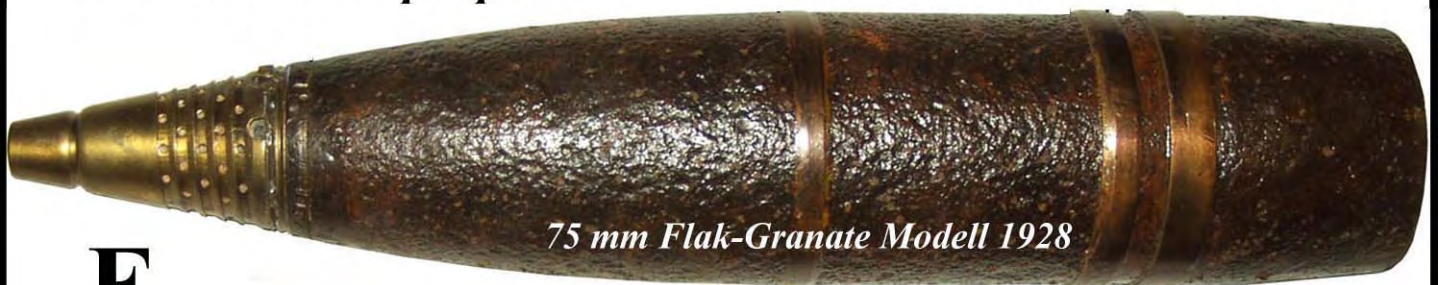
Obus de D.C.A. de 75 mm modèle 1928
