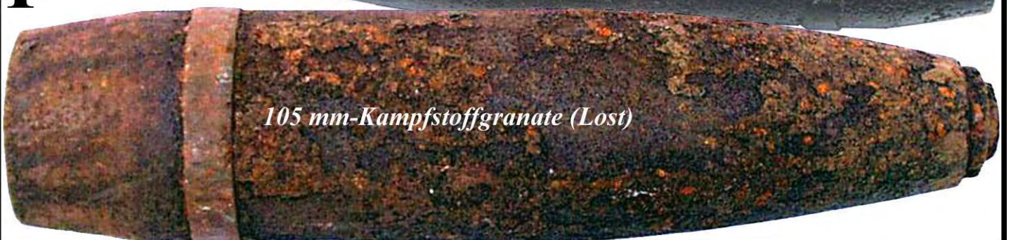
Obus chimique de 105 mm (Ypérite)
