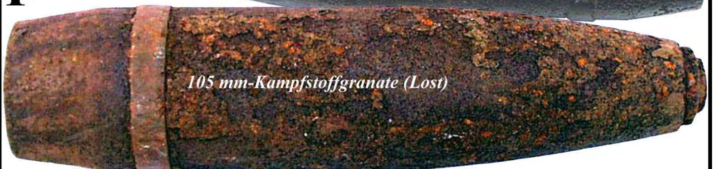
Obus chimique de 105 mm (Ypérite)
