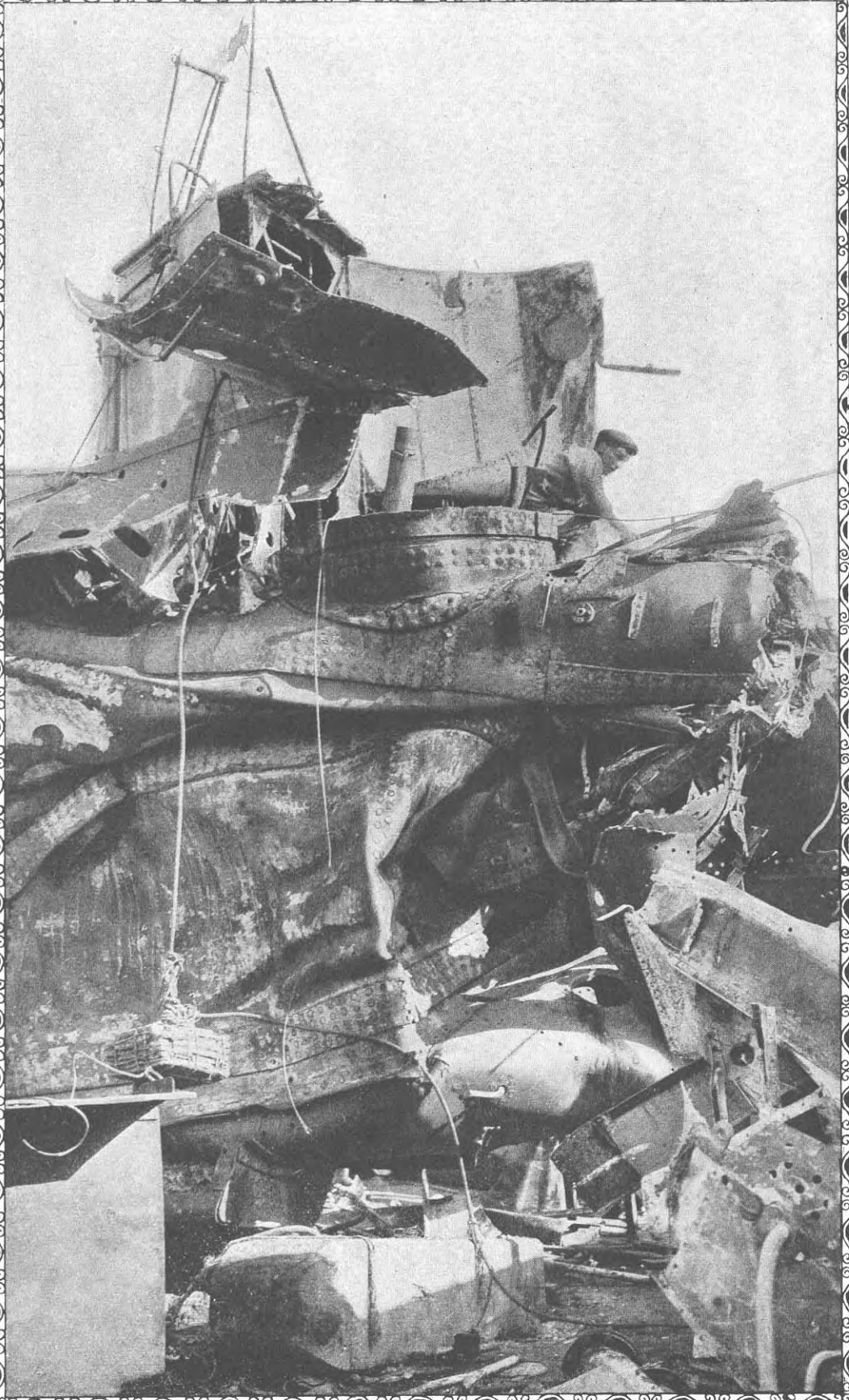
Il sommergibile tedesco «U.C. 12» durante i lavori di riparazione in una nostra base navale.
