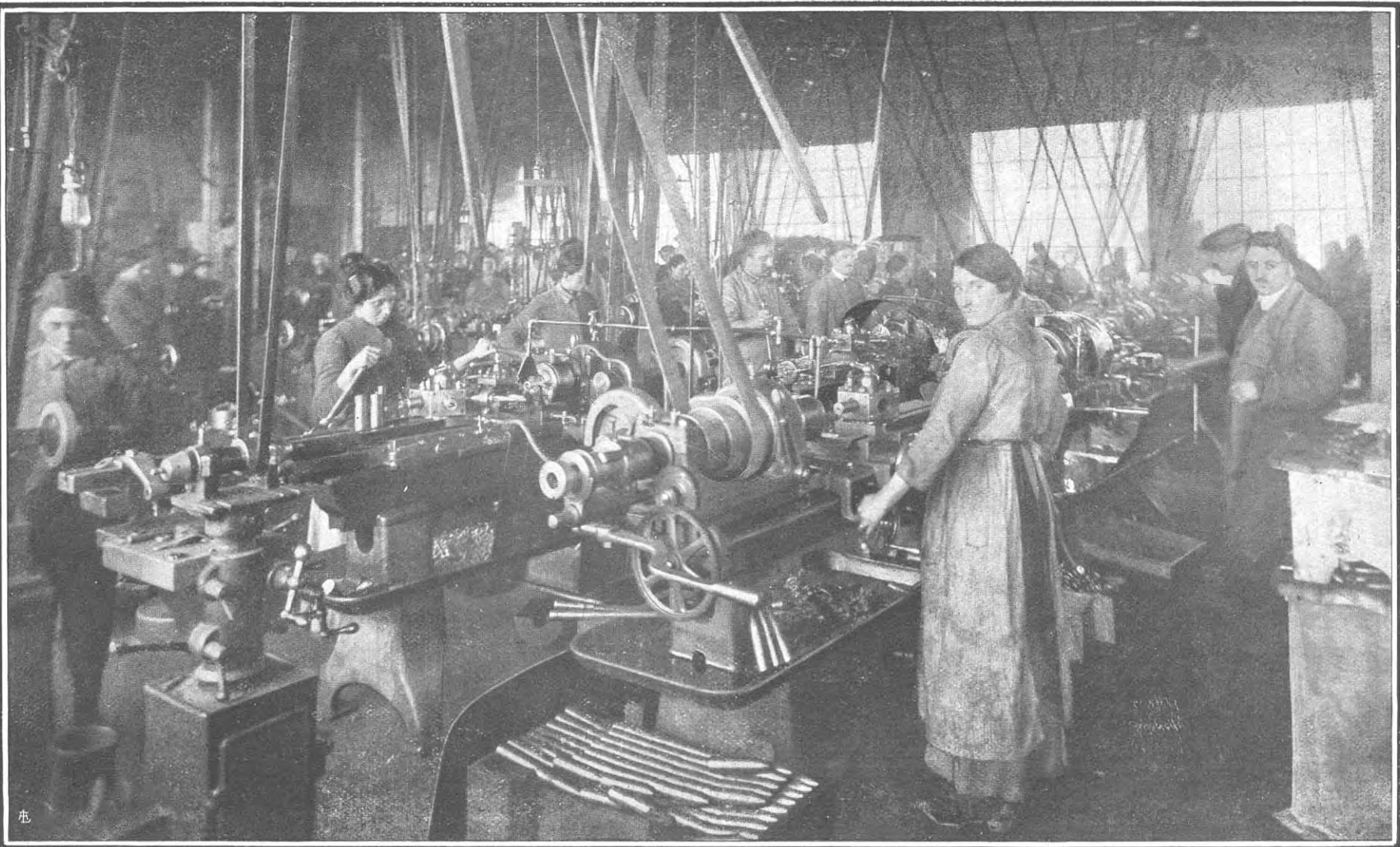
Torni semi-automatici per proiettili di piccolo calibro e parti di spolette, costruiti dalla ditta stessa.
