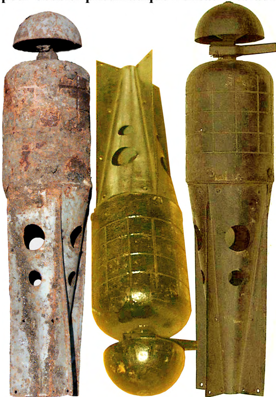
Projectile empenné de 86 mm pour obusier pneumatique Boileau-Debladis
