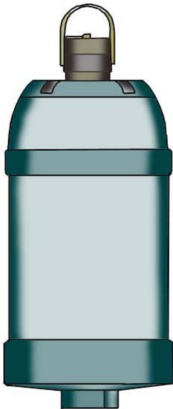
Projectile de 91,3 mm pour mortier lisse type Lanz Variante en service dans les forces austro-hongroises en 1917
